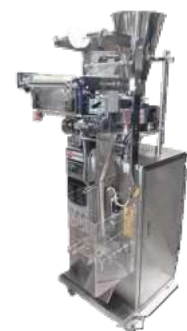
EMBOLSADORA DE GRANOS CON CODIFICADOR INTEGRADO Y FOTOCELDA
